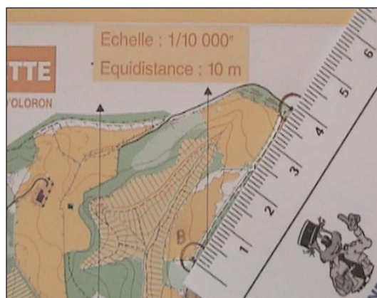
Ex : 7,5 cm sur une carte au 1/25 000 correspond à une distance de 1,875 km.
